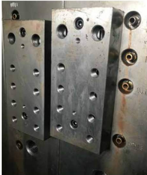
冷却孔采用了很多Rc ( PT ) 的螺纹
